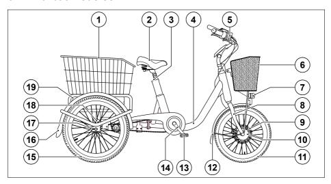
Abb. 6 Pedelec mit Nabenschaltung und Vorderradmotor
