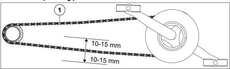
Abb. 30 Kettenspannung prüfen
