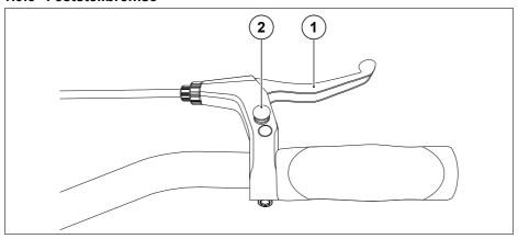
Abb. 17 Feststellbremse
