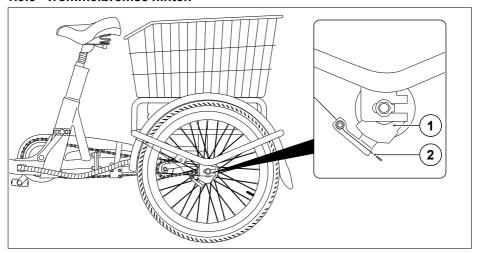
Abb. 16 Trommelbremse hinten
