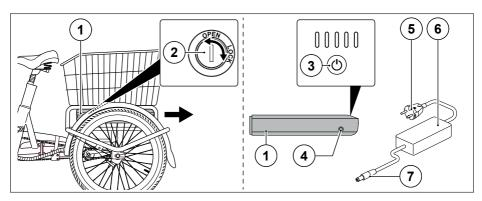
Abb. 7 Akku entnehmen und einsetzen / Akku laden
