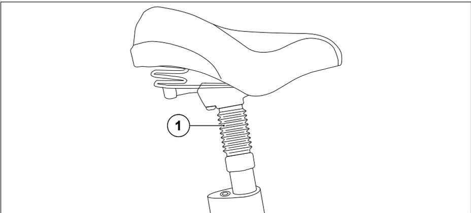
Abb. 21 Gefederte Sattelstütze
