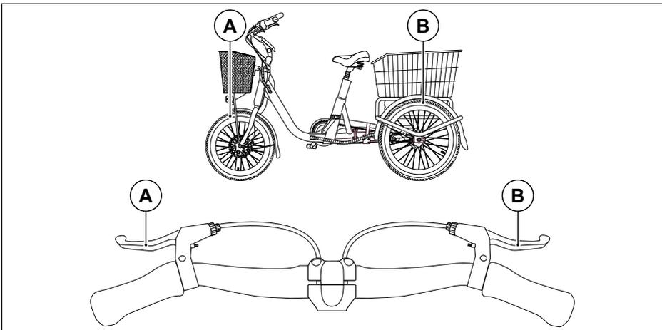
Abb. 12 Bremshebelzuordnung
