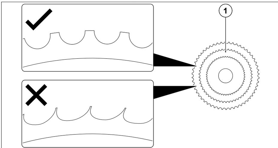
Abb. 29 Zahnkranzverschleiß
