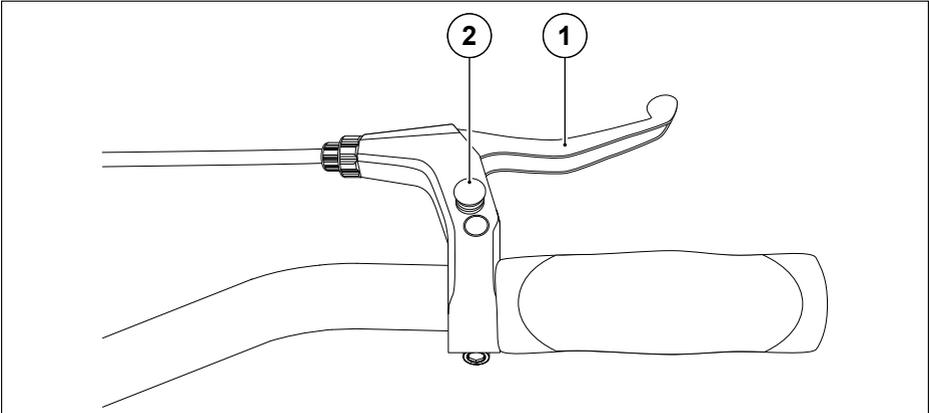
Abb. 17 Feststellbremse
