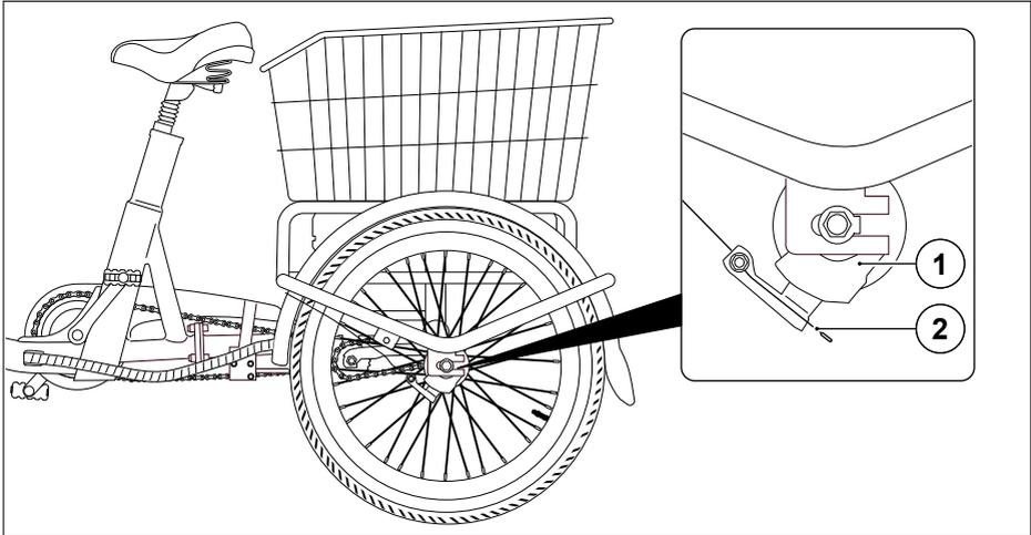
Abb. 16 Trommelbremse hinten
