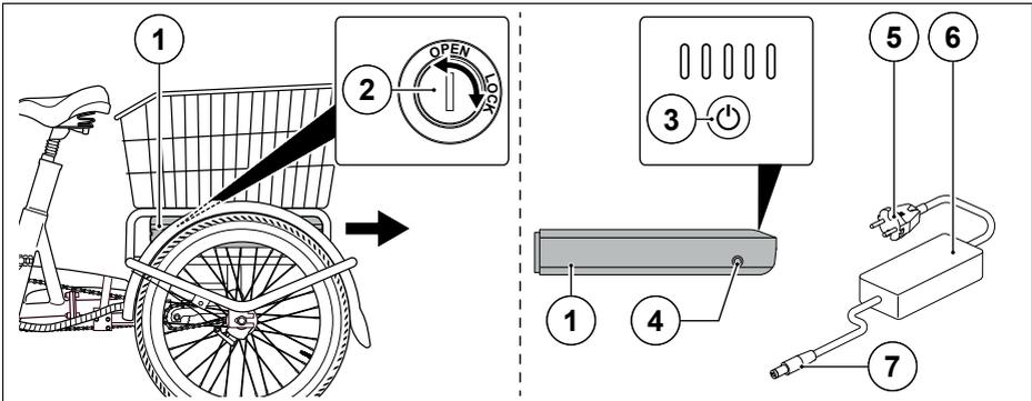
Abb. 7 Akku entnehmen und einsetzen / Akku laden
