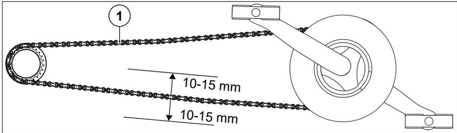
Abb. 30 Kettenspannung prüfen
