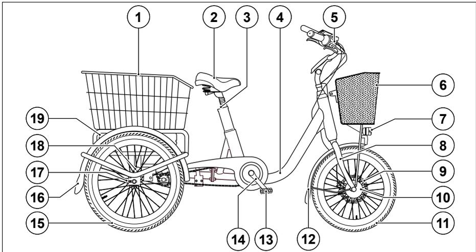
Abb. 6 Pedelec mit Nabenschaltung und Vorderradmotor
